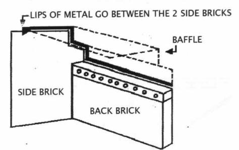
WHEN PUTTING THE BAFFLE INTO THE STOVE TAKE THE CASTLE OUT. THE REMOVE THE RIGHT HAND SIDE BRICK
